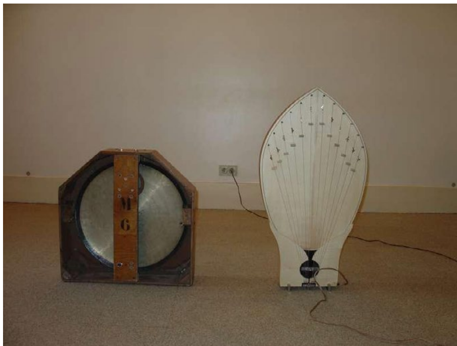
Diffuseurs sans haut parleur à membrane classique : "gong", diffuseur métallique martenot et "palme", diffuseur à cordes sympathiques martenot.
